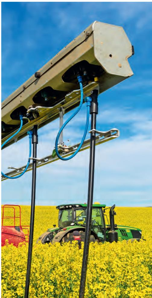
mit Droplegs ausgestatteten Spritzen wird das zum Verhängnis. Am problematischsten sind die Kotflügel, die so sperrig sind, dass die Droplegs nicht frei in der Luft taumeln können, sondern daran zerschellen. Manche Landwirte haben sich Konstruktionen einfallen lassen, um das zu verhindern. Oft hilft aber nur eins: Die Droplegs müssen für die Straßenfahrt abgenommen und am nächsten Schlag wieder neu montiert werden. Das kostet Zeit – und damit Geld.
