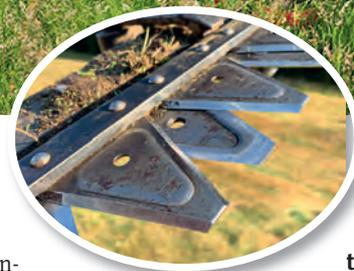
**Balkenmäher sind keine neue Erfindung. Aufgrund der höheren Flächenleistung wurden sie von Kreiselmähern verdrängt. Das Doppelmessermähwerk der Firma BB Umwelttechnik GmbH wurde 2016 mit dem europäischen Bienenpreis ausgezeichnet.**
